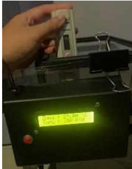
Gambar 15. Proses Pengujian Respon Sensor DS18B20
