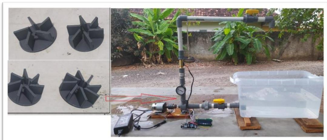
**Gambar 3.** Pengujian pompa dengan variasi jumlah sudu *impeller*
