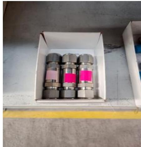
Gambar *Union Swagelok* dengan stiker warna
