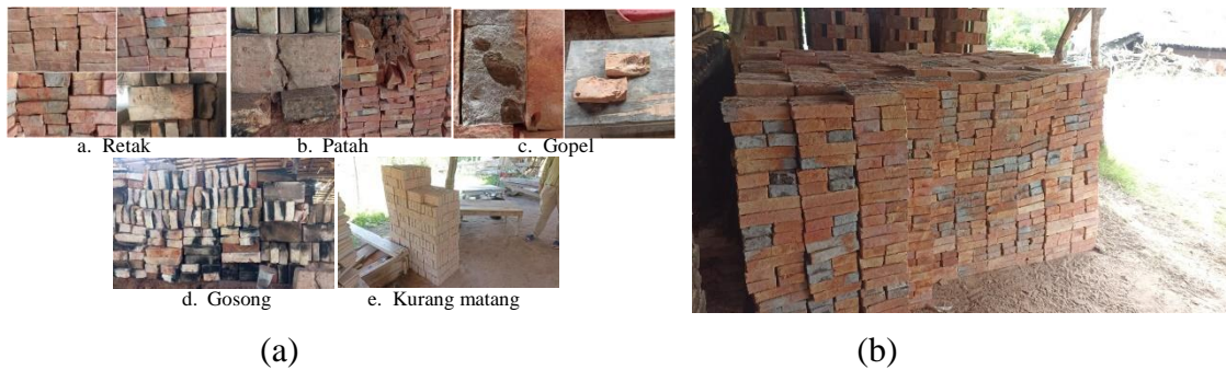
Gambar 1. Gambar produk batu bata cacat dan produk batu bata siap jual
