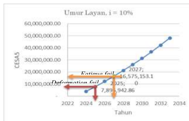
Gambar 2. Grafik Umur Layan Dengan I = 10% Berdasarkan Kegagalan Fatigue Dan Deformation Permanen VDF Faktual 10 Tahun
