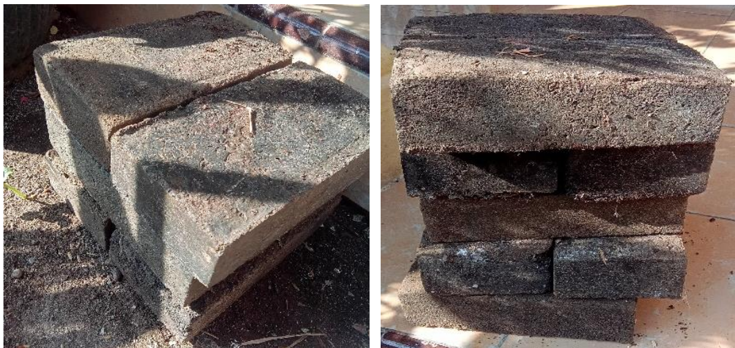
Gambar 5. Hasil Paving Block dari Limbah Plastik
