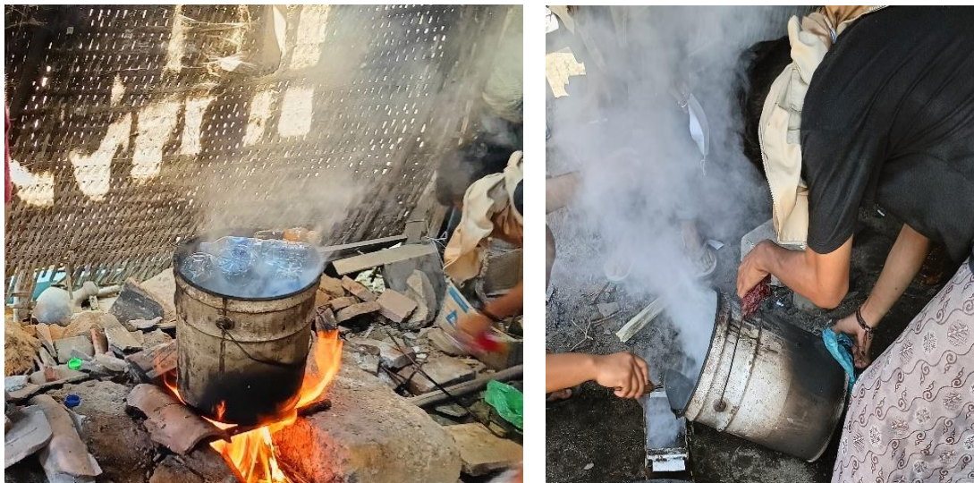
Gambar 3. Proses Pembuatan Paving Block
