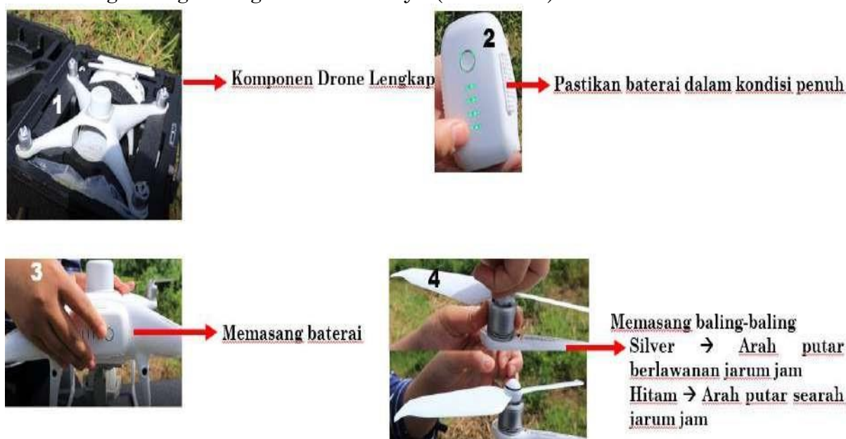
Gambar 8. Pemasangan Komponen Drone
